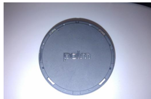
Touchstone mit demontiertem Ring.
